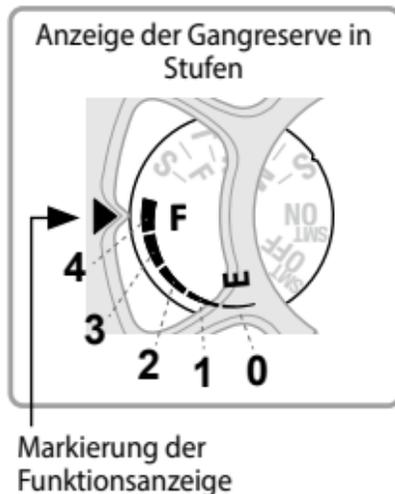
Anzeige des Grads der Stromerzeugung in Stufen
